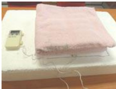
รูปที่ 3 แสดงวิธีการวัดอุณหภูมิของแผ่นประคบความร้อนที่ห่อด้วยผ้าขนหนูหนา 12 ชั้น ด้วยดิจิตอลเทอร์โมมิเตอร์ แบบมีแท่งเหล็ก โดยแท่งเหล็กวางอยู่ระหว่างผ้าขนหนูและแผ่นโฟม
